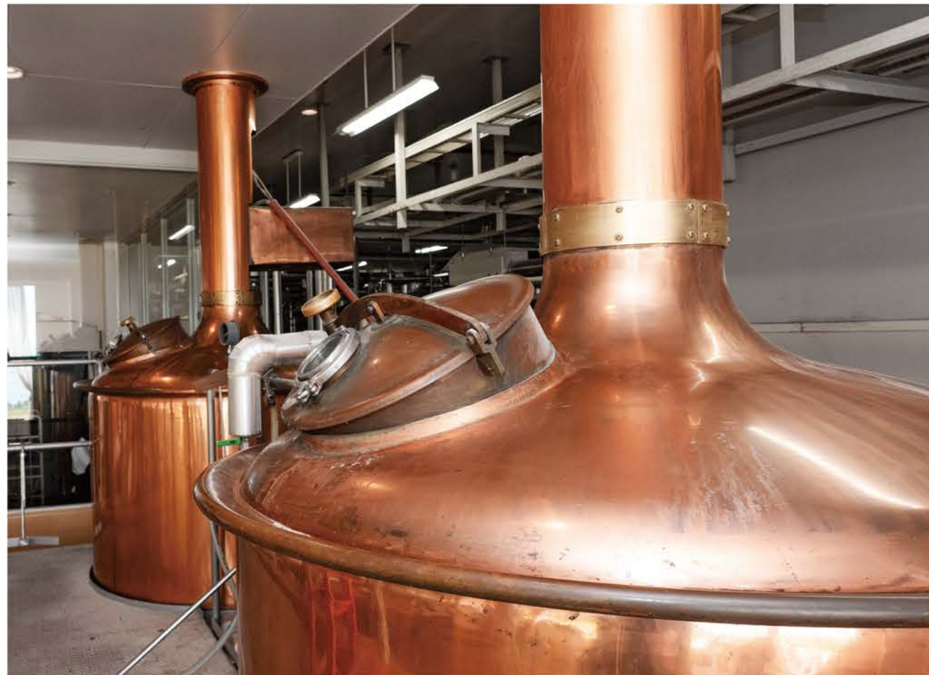
粉碎した麦芽と温水を混ぜ、適温で一定時間おくことで、麦芽のでんぷん質が糖化して麦汁ができる。ろ過した麦汁にホップを加えて煮沸し、発酵・熟成の工程へ。
