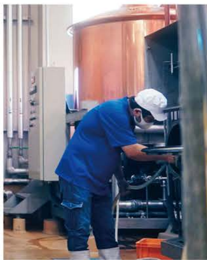
明治の「カブトビール」は、0°Cで3か月間熟成させることで芳醇な味わいに。同じ醸造設備で、オリジナルブランド「知多マリンビール」も造っている。
